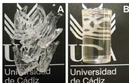
Figura 2.3. Fotografías de los geles obtenidos en nuestro laboratorio: (A) A partir del consolidante comercial TEGOVAKON® V100, (B) A partir del producto sintetizado en nuestro laboratorio.
