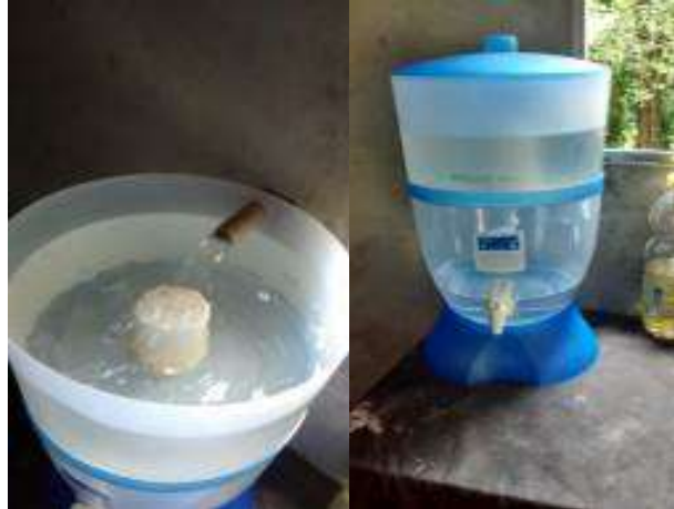
Figura 6 – Estrutura de Tratamento da água da chuva.
