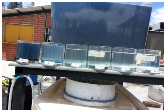
Figura14. Resultados obtenidos en cada sub-celda caudal 4lit/min, V_e = 30v
