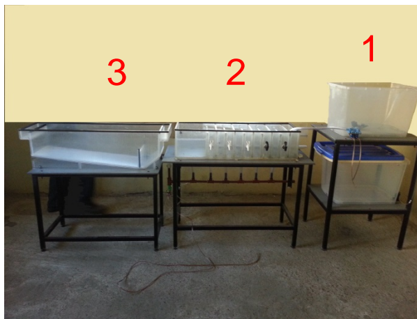
Figura 6. Sistema de electrocoagulación a escala de laboratorio
