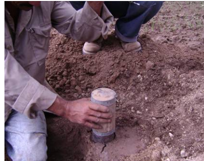
Foto 5. Determinando la densidad del suelo
