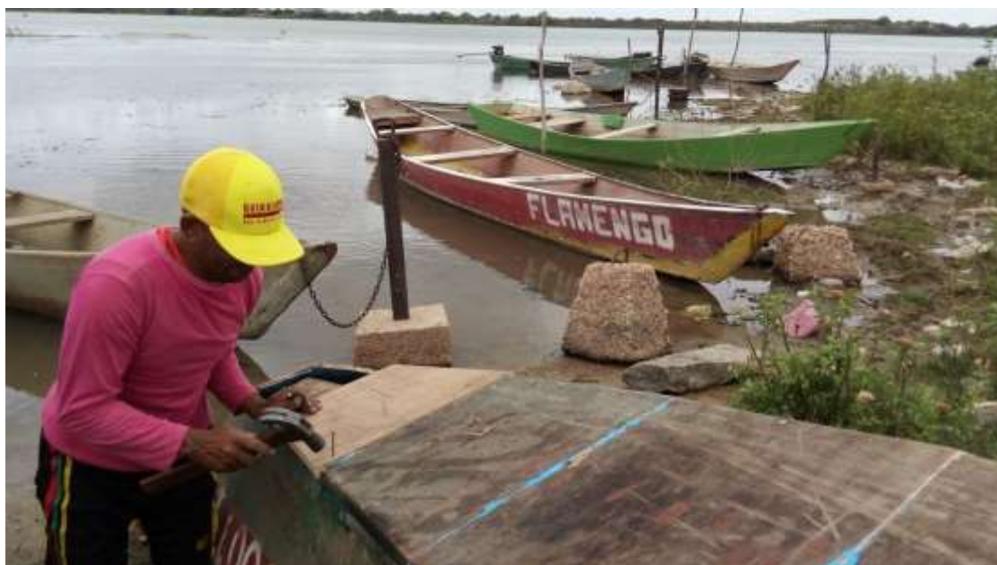
Figura 01: Reparo em canoa e utilização da gordura de peixe como rejunte no casco da embarcação.
