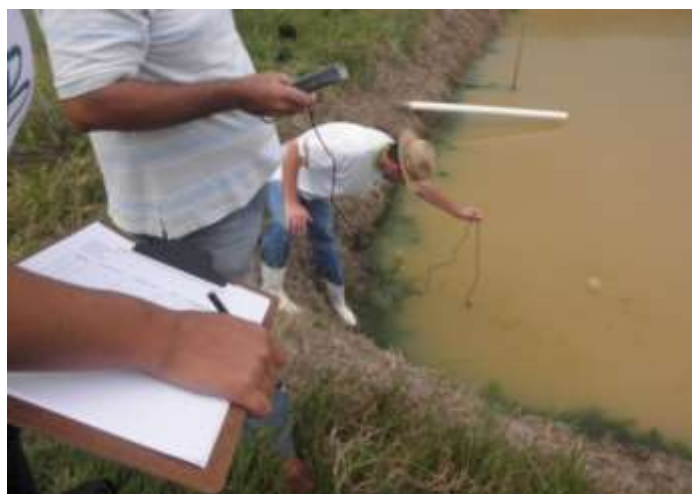
Figura 2- Medição dos parâmetros físicos e químicos da água dos tanques
