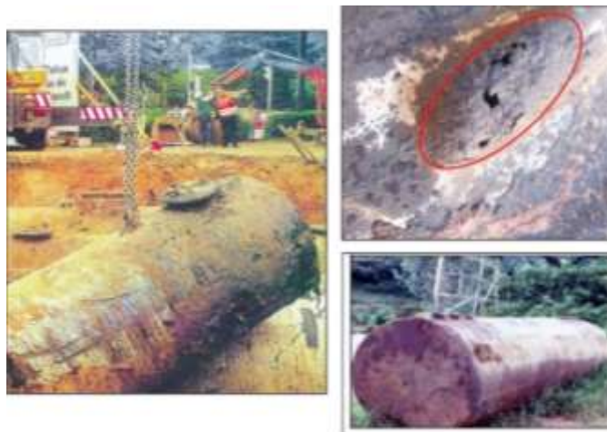
Figura 2 - Tanques de combustíveis de posto em processo de corrosão
