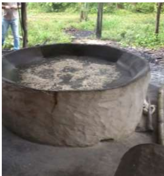
Figura 4: Forno feito de barro, cimento e com tambor de ferro. Fonte: GEPPAM, 2014.
