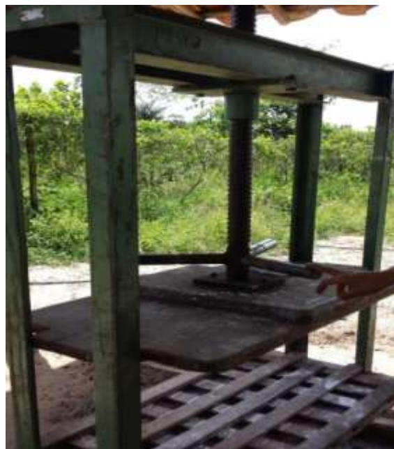
Figura 3 - Prensa manual de extração de tucupi. Fonte: GEPPAM, 2014
