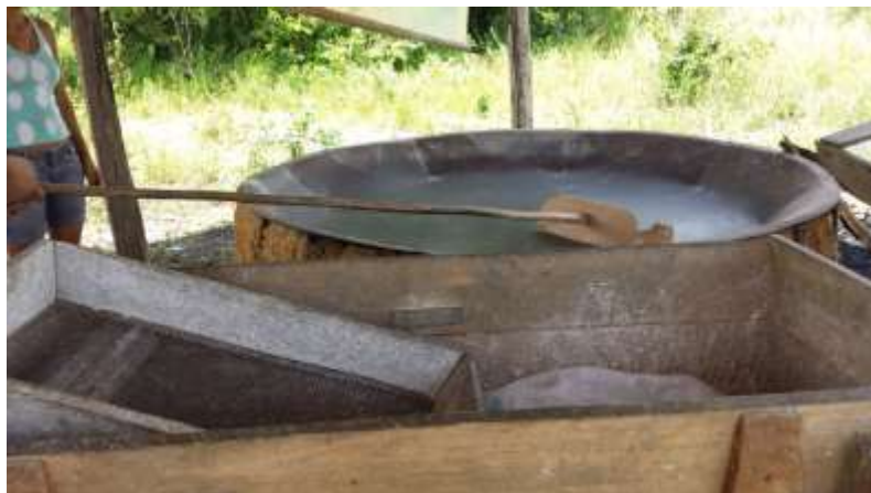
Figuras 6: Objetos da casa de farinha, a : Peneira e tacho que é aquecido sobre o forno. b : Prensa moderna para retirar o tucupi.
