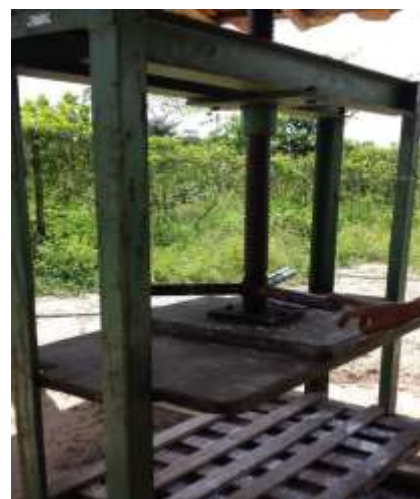
Figuras 6: Objetos da casa de farinha, a : Peneira e tacho que é aquecido sobre o forno. b : Prensa moderna para retirar o tucupi.
