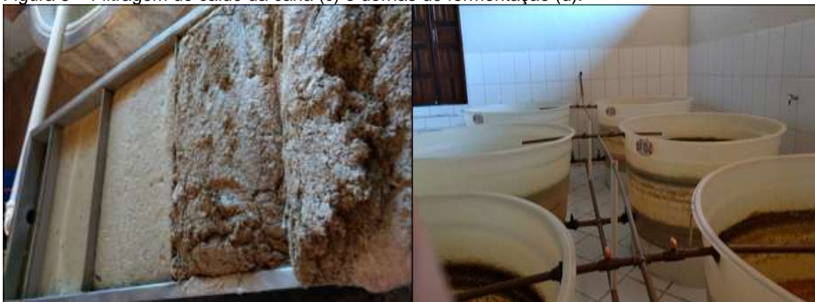
Figura 5 – Filtragem do caldo da cana (c) e dornas de fermentação (d).
