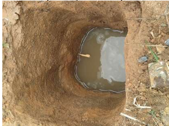
FIGURA 9: Teste de percolação: buraco preenchido com água
