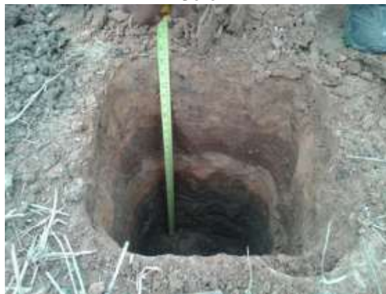
FIGURA 7 : Teste de percolação: representação das camadas do Solo
