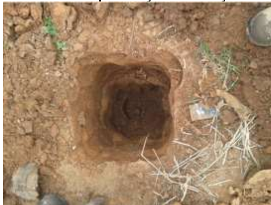
FIGURA 6 : Teste de percolação: escavação do buraco
