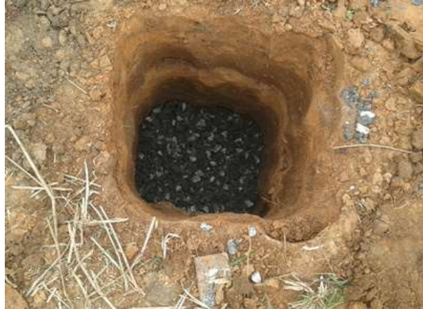
FIGURA 8 : Teste de percolação: buraco preenchido com brita
