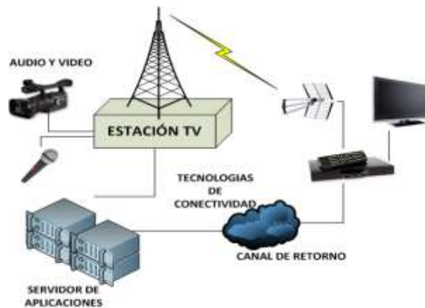
Fig. 5: Canal de retorno para TDT bajo el estándar ISDB-Tb
