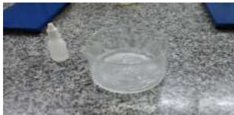
Ilustración 8: Carbopol hidratado en alcohol de 70° previo al agregado de TEA (trietanolamina)
