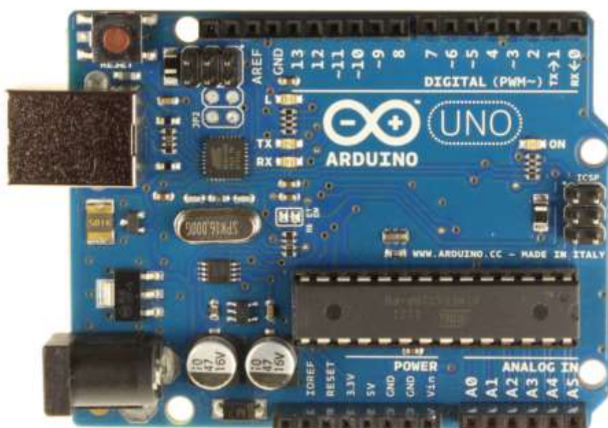
Figura 2 - Arduino UNO
