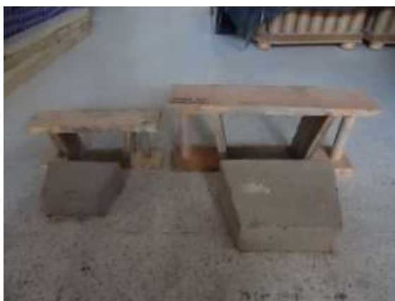
Foto 11, Adoberas con distintas escalas para adobes esviados
