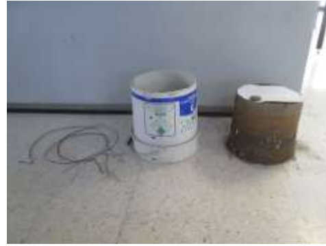
Fig. 6. Molde de Tapial cilíndrico. Foto. Rafael González Alejo.
