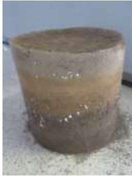
Fig. 5. Tapial cilíndrico Foto. Rafael González Alejo.
