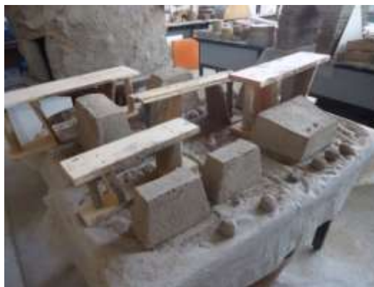
Foto 9, Diversos moldes con sus adobes esviados.
