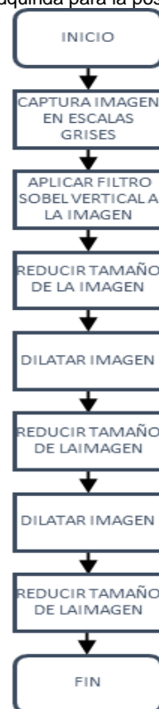
Figura 2: Diagrama de flujo que indica el proceso de simplificación de la imagen adquirida para la posterior detección de obstáculos.
