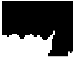
Figura 7: Imagen pasillo de la Universidad Politécnica, después de pasar filtro Sobel vertical y proceso de reducción y dilatación, dejando marcados los obstáculos en color negro y camino libre en color blanco.
