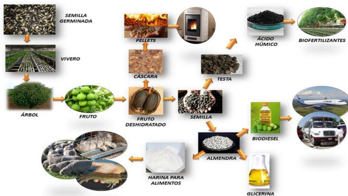
Figura 17. Diagrama del proceso integral del proyecto J. curcas
