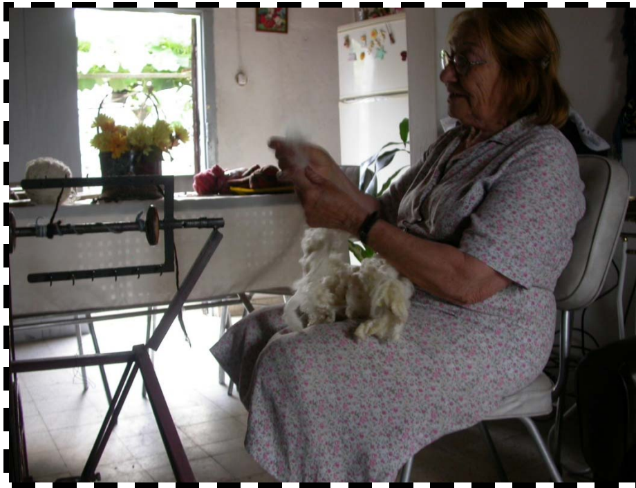
Fotografía -Hilandería Chica de Ansina cardando la lana. También se observa la máquina de hilar a la izquierda de la fotografía.
