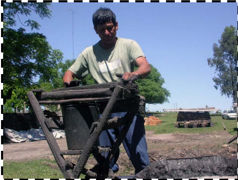
Fotografía -Roberto cortando el ladrillo con el molde que ellos mismos fabricaron.
