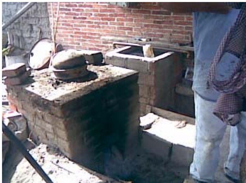
Pequeño horno artesanal con olla de barro para la destilación del mezcal.
