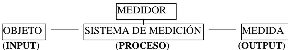
*Figura : Factores del proceso de medición*
